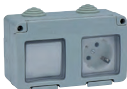
BASE ENCHUFE + CONMUTADOR ESTANCO 9630305 Toma de corriente con TT lateral 16A/250V~ + Conmutador 10A/250V~. IP55. 82x140 mm.
