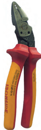
ALICATE CORTE DIAGONAL IRONSIDE 180MM 9697468 Multifunción con cabeza acodada especial para electricistas. Aislamiento 1000 V. Cabezal ergonómico doblado 25°. Ahorro de un 25% de fuerza en el corte. Cortador de múltiples funciones. Capacidad de corte hasta 3,5 mm². Corte diagonal. Corte plano. Engaste. Pela cables. Crimpado de casquillos. Cizalla simple de tornillos de latón. Dispositivo de bucle. Mango de dos componentes.
